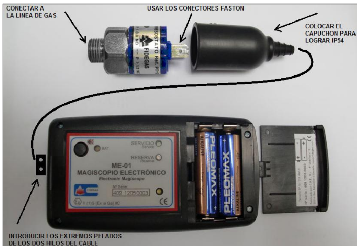
Fig. 1 – Material suministrado: Presostato + Magiscopio Electrónico
