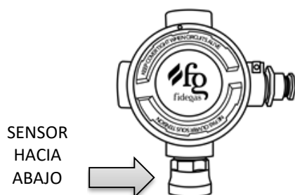
Figura 4: posición correcta de colocación del transmisor.
