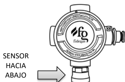
Figura 3: posición correcta de colocación del transmisor.
