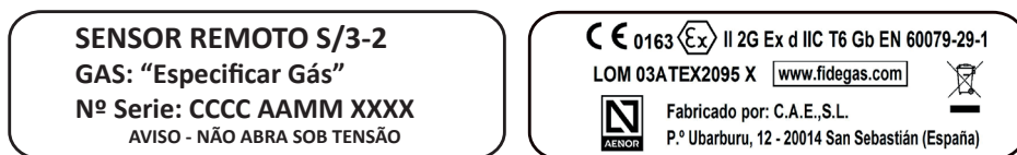
Figura 1: etiquetas de identificação e marcação (o número de série e o gás são especificados na secção 7)
