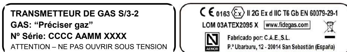
Figure 1 : Étiquettes d'identification et de marquage ( le numéro de série et le gaz sont spécifiés dans la section 7 )
